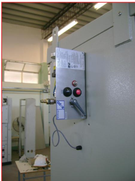
Vista del sistema de presurización por accionamiento de corte neumático e indicador de estado mecánico, con paso de rojo en estado de carga y verde en estado presurizado
